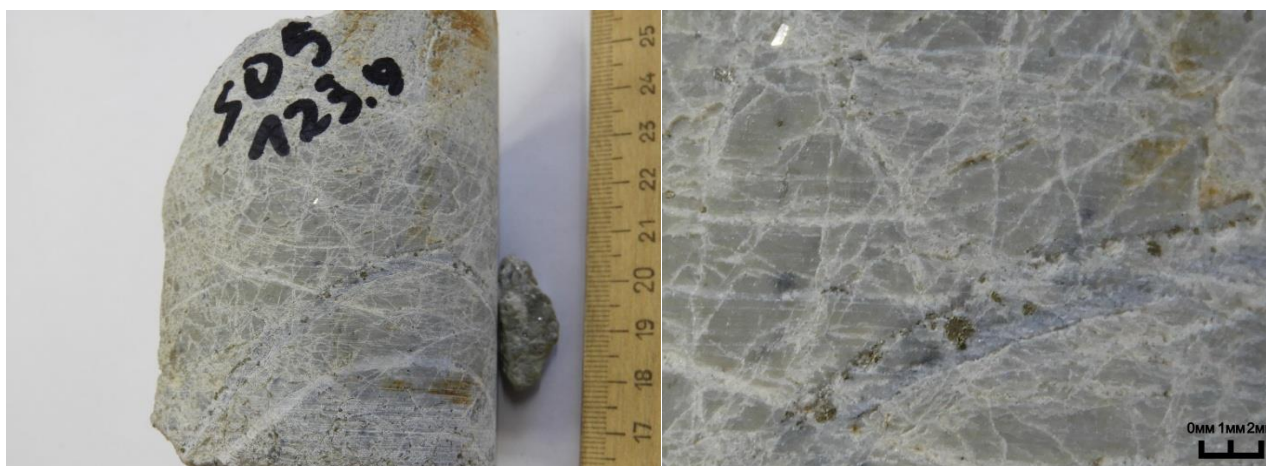
Рисунок 3 - Образец керна скважины с золотосульфидной минерализацией (пирит, арсенопирит). Имеет массивную текстуру и тонкокристаллическую структуру
