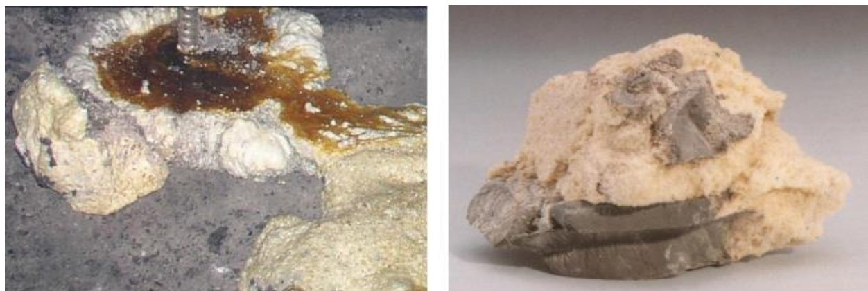
Рисунок- 1. Полиуретановая смола Беведол – Беведан: а – виде покрытия; б – закрепления массива
