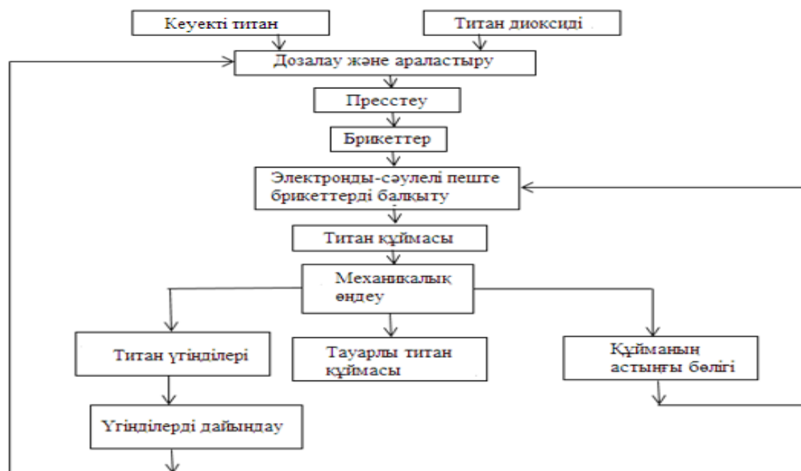
Сурет 1 - Титан қорытпасын алудың технологиялық сұлбасы
